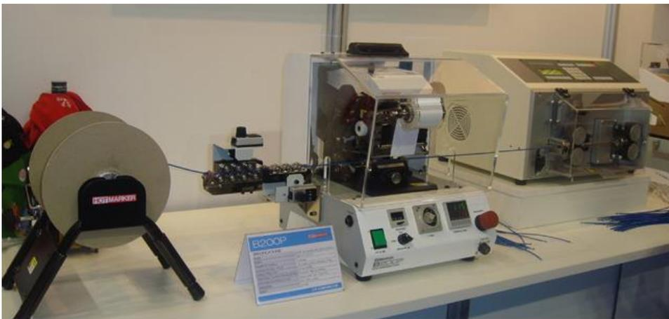
**Beispiel** einer Fertigungslinie mit Einzieh- Abläng- und Abisolierautomat sowie Beschriftung mit unserem Markiergerät, Type B200P.
