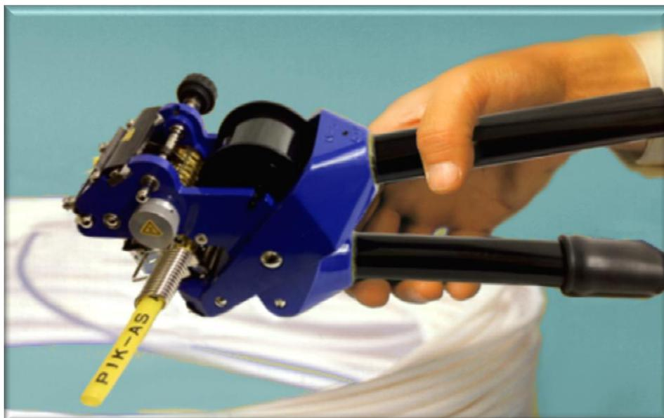
С ПОМОЩЬЮ ЭЛЕКТРИЧЕСКИХ ЧЕКАНОЧНЫХ ЩИПЦОВ **M3E** МОЖНО МАРКИРОВАТЬ ОТДЕЛЬНЫЕ ЖИЛЫ, КАБЕЛЬ И ТРУБКИ ИЗ ТЕРМОУСАЖИВАЕМОГО МАТЕРИАЛА. ЗНАКИ ВЫПЛАВЛЯЮТСЯ НА ТРЕБУЕМОМ МАТЕРИАЛЕ ГОРЯЧИМИ КОЛЁСИКАМИ, НАХОДЯЩИМИСЯ НАД ПОЛИЭТИЛЕНОВОЙ ПЛЁНКОЙ С ТОНКИМ ЦВЕТНЫМ СЛОЕМ. ИНСТРУМЕНТ МОЖНО ПРИМЕНЯТЬ ДЛЯ СРЕДНЕГО СЕРИЙНОГО ПРОИЗВОДСТВА КАК НА ЗАВОДСКОМ ПРЕДПРИЯТИИ, ТАК И НА СТРОИТЕЛЬНОЙ ПЛОЩАДКЕ.
